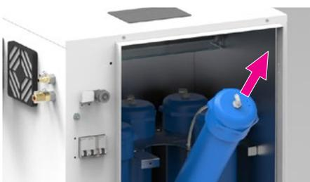
10: Successivamente rimuovere la seconda staffa di blocco che trattiene i contenitori posti sul fondo del dispositivo svitando le 2 viti superiori e sollevandola verso l'alto.
