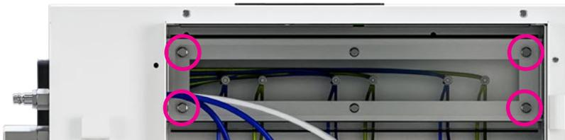
7: Sfilata la protezione si avrà accesso alla morsettieria nella quale si dovranno scollegare i 12 cavi di alimentazione dei generatori (un cavo blu ed uno giallo/verde per ogni contenitore) con apposita chiave inglese da 7mm.
