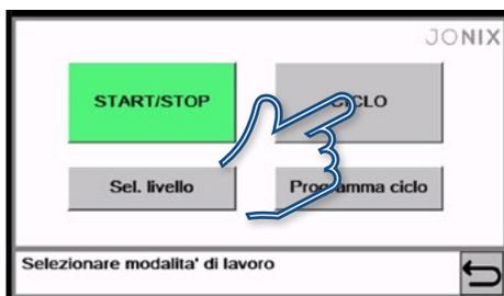
La differenza tra i due cicli consiste che il primo, viene attivato dal consenso dal galleggiante entro il serbatoio e dopo il trattamento attende lo svuotamento del serbatoio per ripartire con un nuovo riempimento; mentre il secondo continua a trattare il liquido dentro al serbatoio in maniera continua alternando tempi di attivazione a tempi di pausa.
