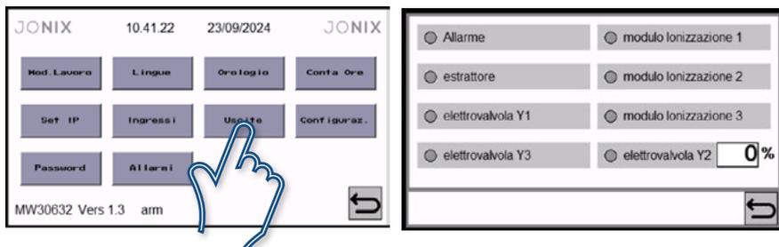
I pallini posti a lato delle scritte segnalano se l'uscita corrispondente è attiva o non attiva (pallino verde = attivata; pallino grigio = non attiva). Il display, tramite software, invia alla centralina dei comandi e quest'ultima li trasforma in cambio di stato sui vari relè di gestione.
